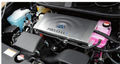
Pile à hydrogène d'une voiture électrique.
